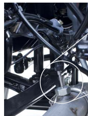
Inyección de urea al sistema de escape, reduce la emisión de los niveles de Óxido de Nitrógeno (NOx).
