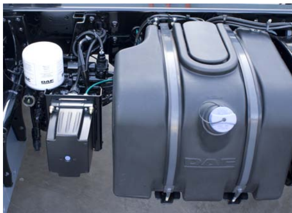
Tanque DEF, unidad dosificadora y filtro de aire del sistema.
