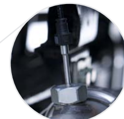
Inyección de urea al sistema de escape, reduce la emisión de los niveles de Óxido de Nitrógeno (NOx).
